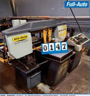
**HYD-MECH** S20A AUTOMATIC HORIZONTAL BAND SAW
